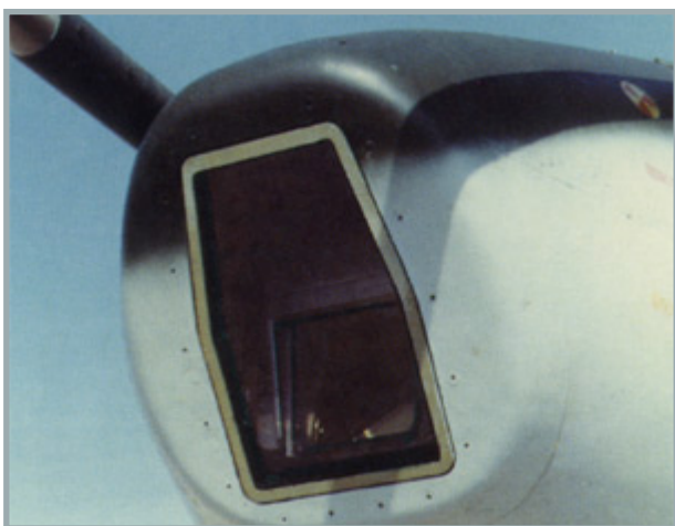
4-5: Laser télémètre / système dation de cible "Klen-PS" du Su-25.
