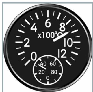
2-13: Indicateur de température en sortie de turbine
