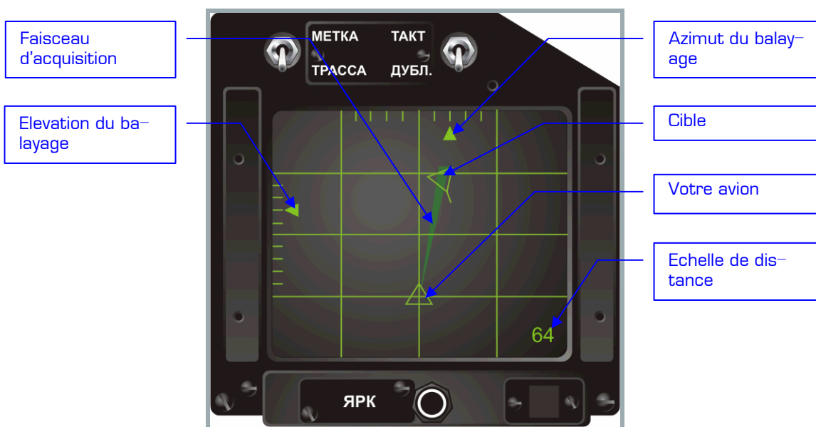
2-25: La VTB en mode АТАКА – РНП (АТТАСK – STT)
