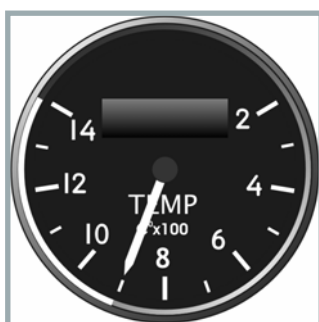
3-13Indicateur de température d'entrée turbine (FTIT)
