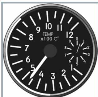
3-52: Indicateur de température de turbine
