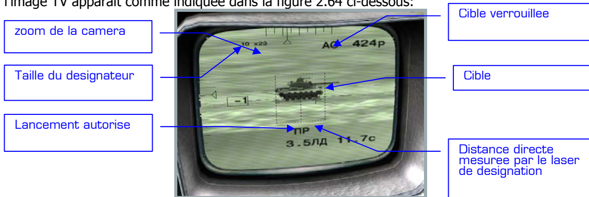
2-64: Affichage TV IT-23M; Cible verrouillée par le "mode"
