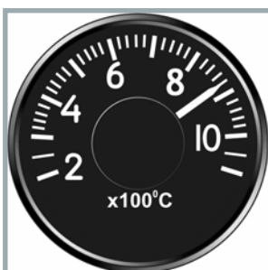
2-47 : Indicateur de température en sortie de turbine
